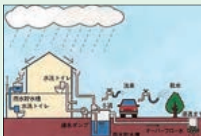
雨水利用システム
